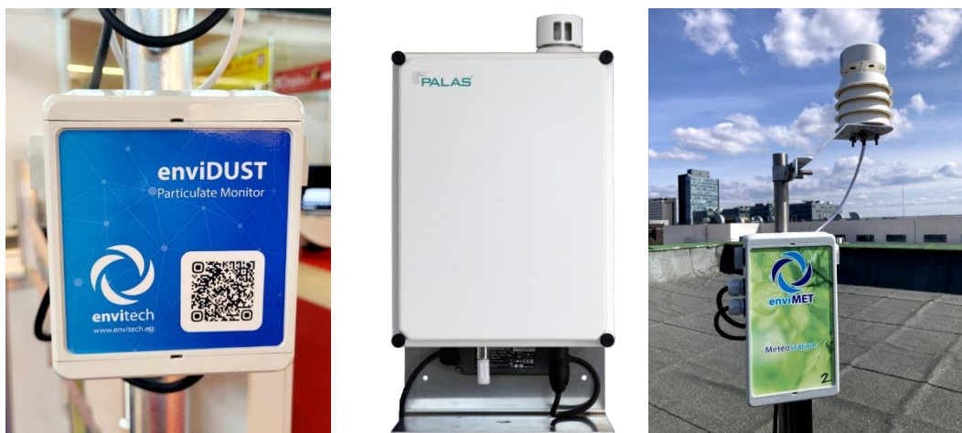
Zleva: Prachoměrná senzoričká jednotka enviDUST, prachoměr AQ Guard Smart 1000 certifikovaný dle mCERTS, senzoričká meteostanice enviMET.
